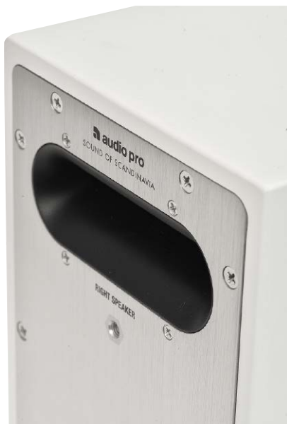
W tylne ścianki obydwu zespołów wkomponowano owalne tunele bas-refleksu.
